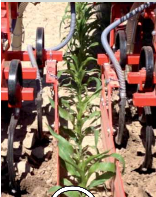
Tubo di calata abbinato a stivaleto interruttore: Ercole viene convogliato da un tubo rigido accoppiato allo stivaleto che provvede al suo interrimento e copertura.
