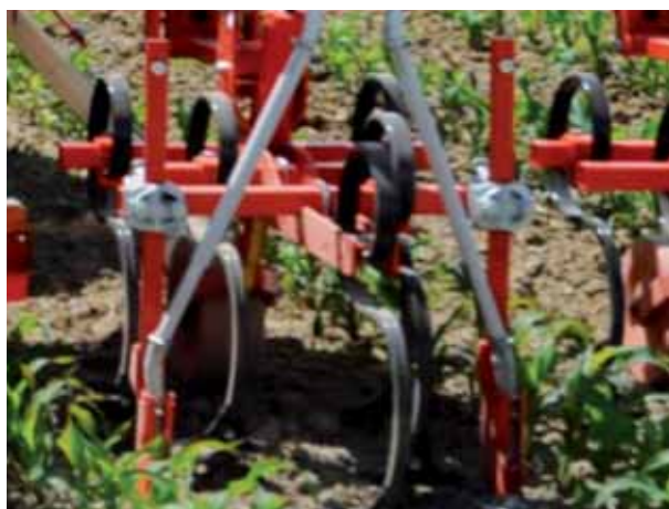
Tubo di calata abbinato a stivaleto interruttore: Ercole viene convogliato da un tubo rigido accoppiato allo stivaleto che provvede al suo interrimento e copertura.
