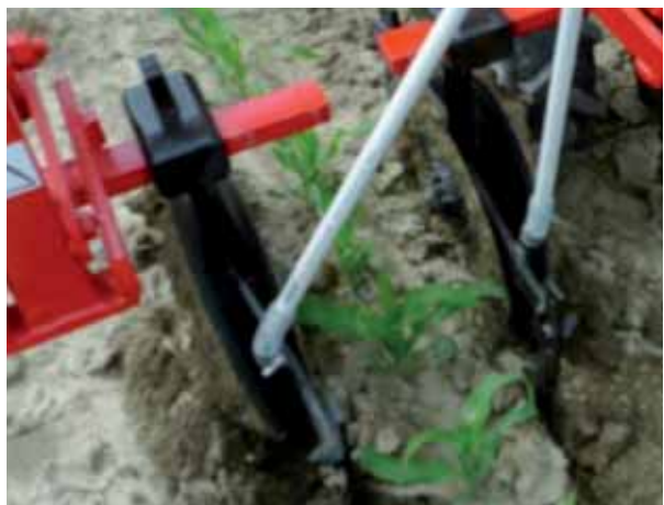
Tubo di calata abbinato ad interruttore a doppio disco: Ercole, veicolato da un tubo rigido, viene distribuito attraverso interruttore a doppio disco.
