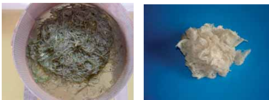
Foto 17. Tiglio di ortica in fase di lavaggio (a sinistra) e fibra dopo il lavaggio e l'asciugatura (a destra). (Foto N. Di Virgilio e S. Baronti)
