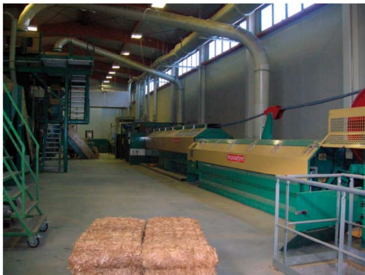
Foto 19. Impianto di stigliatura di Ecocanapa, Comacchio (FE) (Foto S.Baronti)
