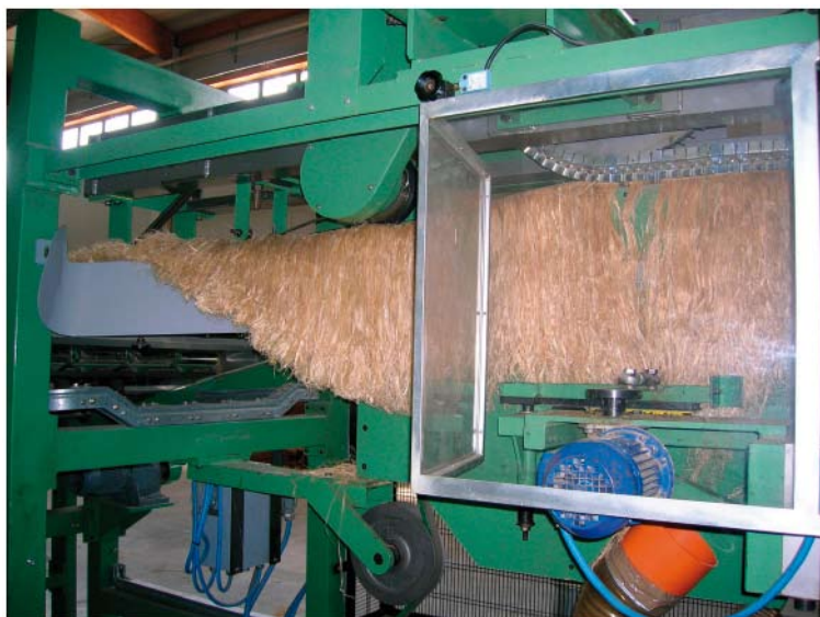
Foto 20. Impianto di pettinatura di Ecocanapa, Comacchio (FE) (Foto S.Baronti)
