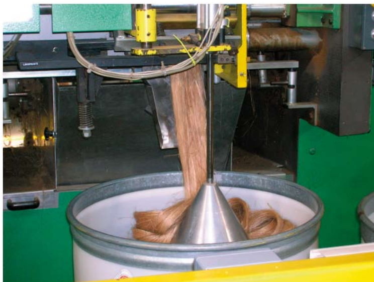
Foto 22. Impianto di pettinatura (particolare) di Ecocanapa, Comacchio (FE) (Foto S.Baronti)
