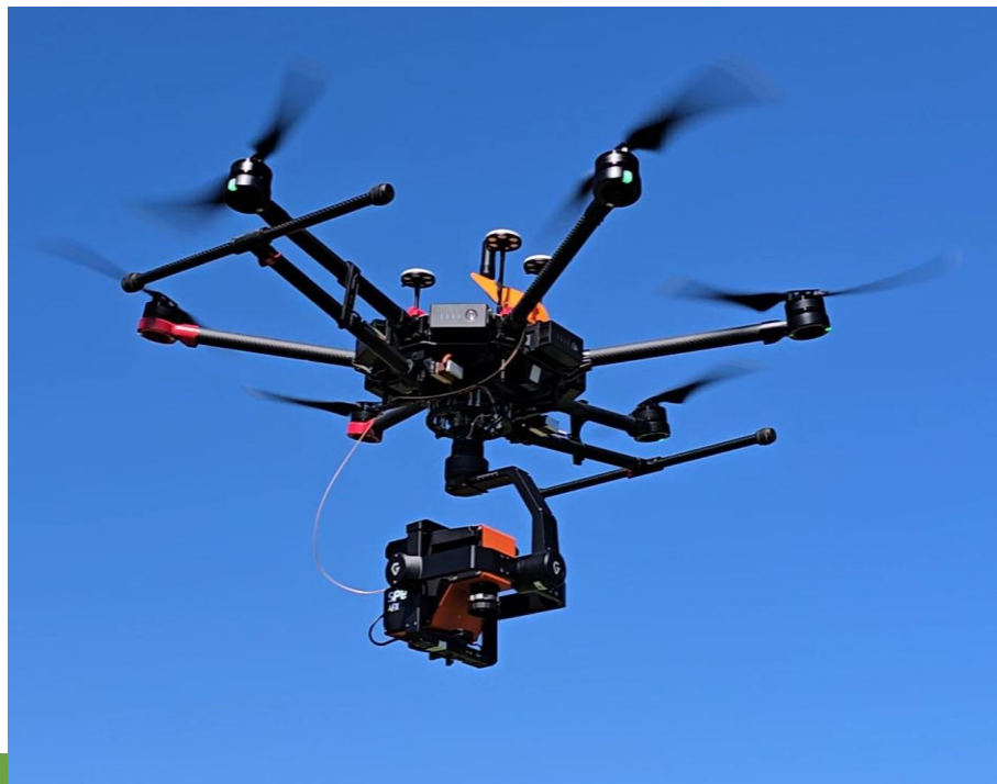
Matrice 600 – DJI Camera iperspettrale SPECIM AFX17 & AFX10
