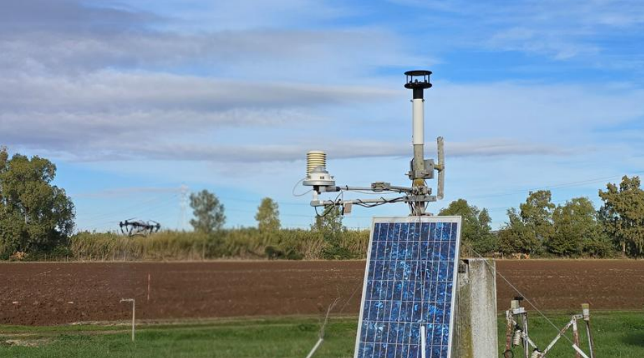
Monitoraggio dati meteo (vento, temperatura, umidità) durante i test di calibrazione
