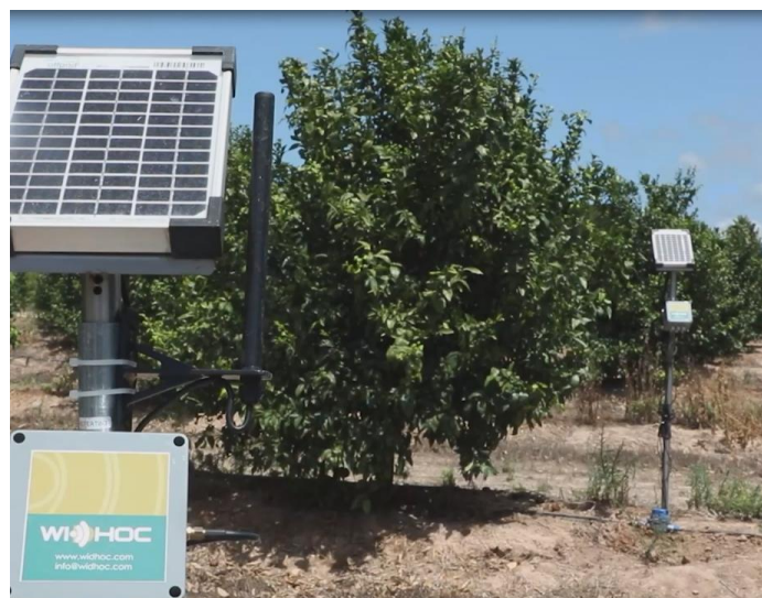
Fig. 3. Sonda capacitiva in una piantagione di agrumi simile a quelle utilizzate in GO GO AVOCADO
