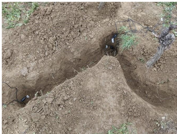
Fig. 2: Uso della sonda capacitiva per studiare il comportamento dell'acqua nel suolo - GO OFIVO
