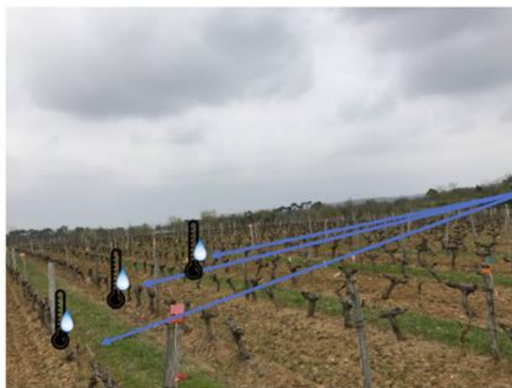
Fig. 4. Sensori che monitorano umidità e temperatura vicino alle gemme in tre diversi trattamenti di gestione del suolo - SICTAG EU
