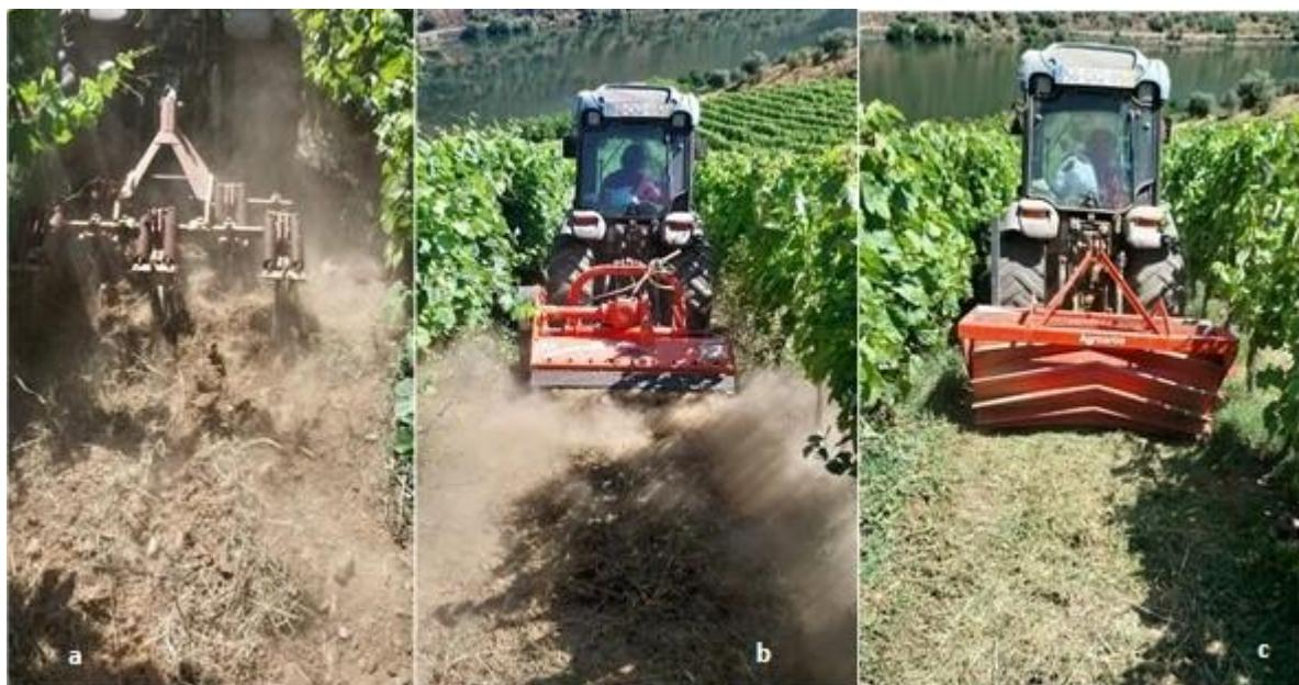
Fig. 5. a) TILL - terreno lavorato, b) MOW - sfalcio della vegetazione, c) ROLL - rullatura<sup>23</sup>
