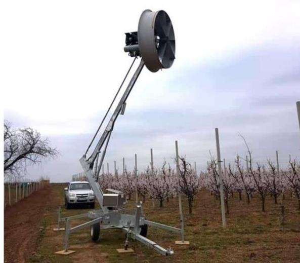
Fig. 10. Ventole per la protezione dalle gelate primaverili<sup>20</sup>
