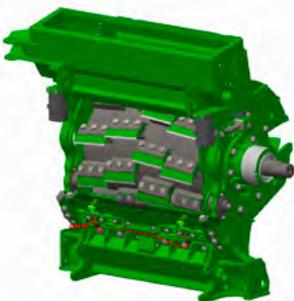
Il sistema ProCut controlla la regolazione della controlama e l'affilatura dei coltelli, tramite due sensori fissati sulla controlama. La tecnologia dei sensori è progettata per misurare tutti i parametri di ogni singolo coltello anche alla massima velocità di rotazione del
