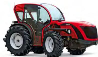
diametro inferiore alle posteriori, garantiscono maneggevolezza, disimpegno tra i filari e volte strettissimo, anche in pendenza. È ottimale per le lavorazioni sottochioma, nei frutteti a ypsilon, nei vigneti a tendone e nelle serre. Allestito con cabina super-low profile pressurizzata Protector 100 (altezza 1.740 mm) per preservare l'operatore durante i trattamenti. La cabina è certificata in Cat. 4 N° EN-15695-1.
