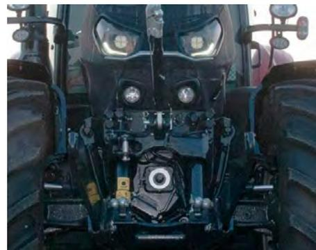
Selezionando la velocità 1.000ECO della presa di potenza anteriore, insieme alla 1.000ECO di quella posteriore, il regime nominale è disponibile, per entrambe, a 1.585 giri motore. Permettendo così l'utilizzo, in contemporanea, di attrezzature con un carico di lavoro ridotto a un regime motore a cavallo della coppia massima. Questo permette un risparmio sui consumi di carburante e un funzionamento silenzioso, a vantaggio del comfort per l'operatore.
