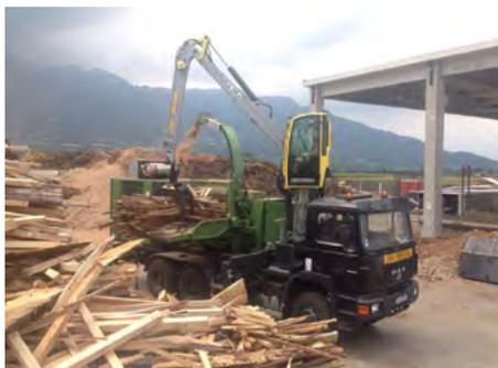
ottenere un maggiore peso utile di carico, una riduzione sensibile dello sforzo sulla struttura del caricatore e sulle sospensioni dell'autocarro. La macchina si caratterizza per avere portiere e finestre in policarbonato resistenti agli urti per una maggiore sicurezza dell'operatore; un sistema di sollevamento integrato con rallentamento di fine corsa in salita e discesa e guide di scorrimento in teflon in modo da ridurre al minimo le sollecitazioni.
