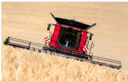
una potenza massima di 400 CV e il modello 7140 Cross Flow, anch'esso con il motore da 8,7 L Stage IV e con una potenza massima di 449 CV. A valle del rotore un nuovo sistema a sei coclee sostituisce il precedente sistema a cinque, trasportando il prodotto in modo efficiente e con una maggiore capacità ai crivelli, dove un nuovo sistema di compensazione delle pendenze laterali assicura un flusso del prodotto ottimale.
