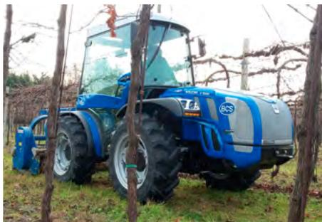
la propensione al compattamento del terreno. L'esclusivo doppio sistema di sterzo Dualsteer che accomuna le doti di stabilità della versione a ruote sterzanti con la manovrabilità della versione con articolazione centrale consente inoltre raggi di volta estremamente contenuti. La postazione di guida reversibile consente di lavorare con l'attrezzatura posta frontalmente, vigilando costantemente e con estrema precisione sulle lavorazioni a tutto vantaggio del comfort e della sicurezza.
