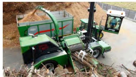
m e gira di circa 45°. Gruppo cippatore: il tamburo è stato progettato per produrre cippato a pezzatura grande, così da riflettere al meglio le richieste delle centrali più moderne e in particolare degli impianti di gassificazione.
