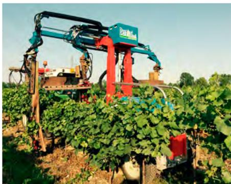
L'Arcobaleno Multifunzione nasce per poter effettuare varie lavorazioni nel vigneto, come cimatura, diserbo, trattamenti, applicando su un unico telaio le specifiche attrezzature. Tramite presa di forza si azionano due pompe a membrane, una per l'erogazione/diserberbo e l'altra per il recupero, e un generatore 24 V con tecnologia brushless per alimentare le elettroventole nei
